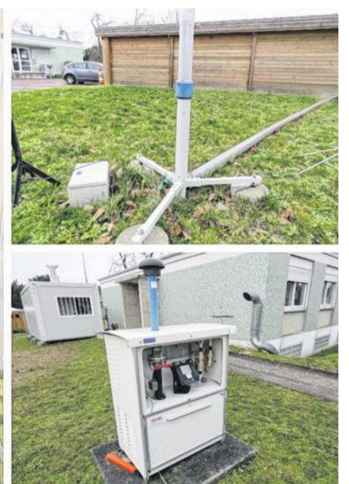
Maxime Morin, chef du laboratoire de surveillance de l'environnement par échantillonnage à l'IRSN, au Vésinet où sont implantés une sonde Téléray (en haut) et une sonde Opéra (en bas).
